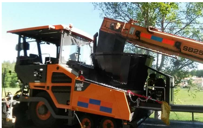
Figur 23. Cabola monterad i asfaltläggarens tråg.
