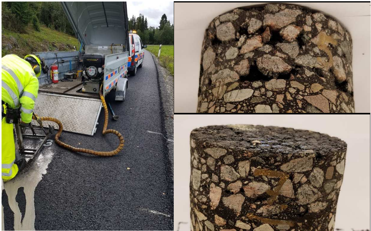
Figur 18. Borring hålrums halt: Översta kärnan lastbyte Push-off-Push-off, nedersta Push-off-bottentöm.
